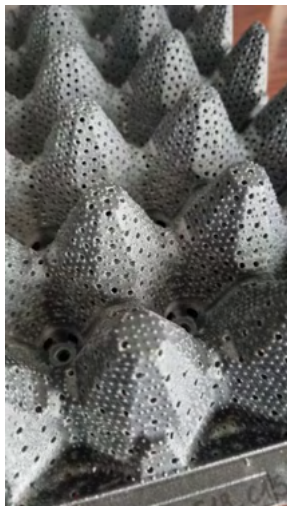
3D printētā šķiedru materiālu iegūšanai un īpaši projekta vajadībām pielāgotā forma ar ulabotu funkcionalitāti
