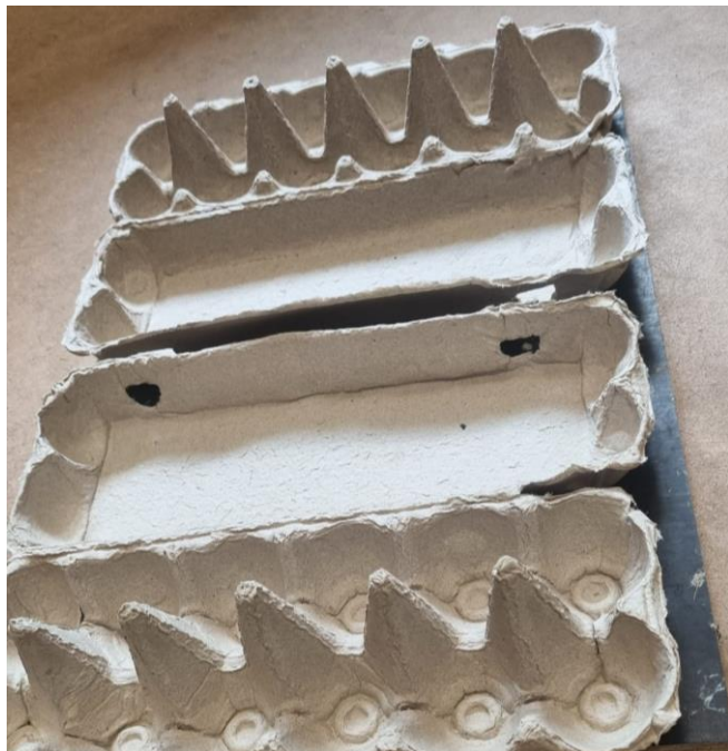
Laboratorijas tipa pilotiekārtā radītie šķiedrmateriālu prototipi TRL 5
