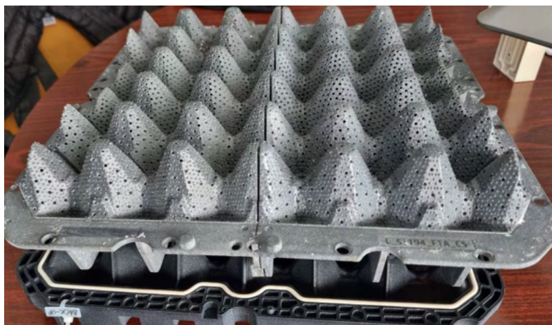
3D printētā šķiedru materiālu iegūšanai un īpaši projekta vajadībām pielāgotā forma ar ulabotu funkcionalitāti
