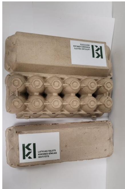
Laboratorijas tipa pilotiekārtā radītie šķiedrmateriālu prototipi TRL 5
